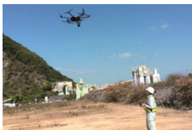
ドローンによる航空写真測量
