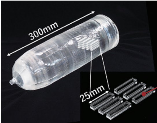
シンチレータ単結晶およびPET検査装置用素子 *5)
