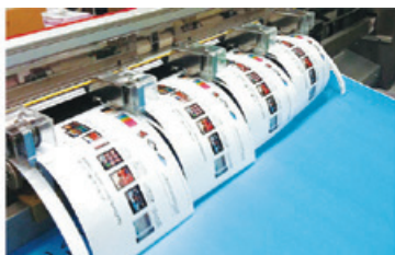
ポスターのカット作業は専用の機械で行う
